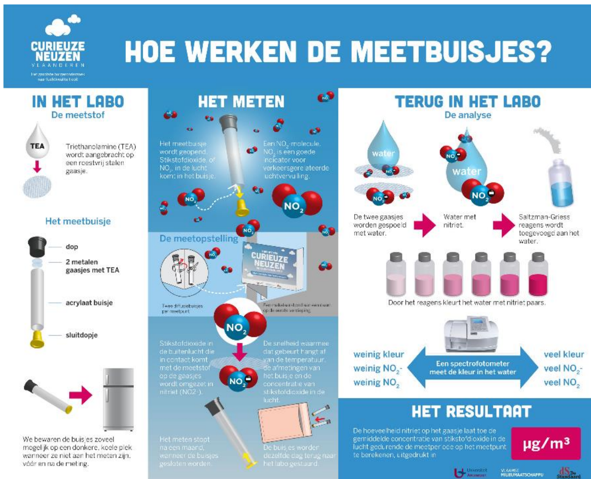
Figuur 1: Werking van passieve samplers (infobrochure CurieuzeNeuzen)
