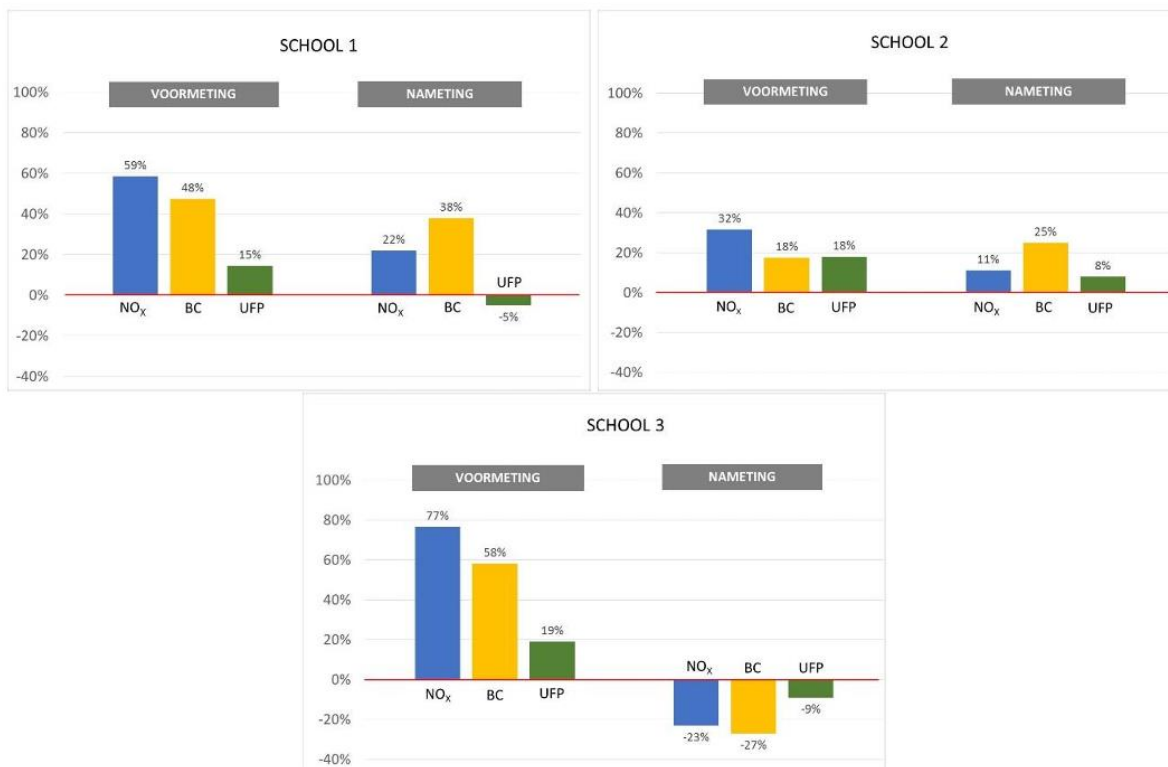
Figuur 3-5 Percentage verandering in concentratie van verkeerspolluenten (NO x , BC en UFP) bij 3 scholen tijdens de ochtendspits ten opzichte van een referentieperiode op dezelfde dag net voor de ochtendspits.
