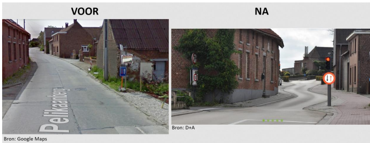
Figuur 3-34: aanleg van (dubbelrichting) fietspad in Sint-Pieters-Leeuw (Pelikaanberg) waarbij één rijstrook van het autoverkeer wordt vervangen door een fietspad (Bron: Fietsberaad 50 )
