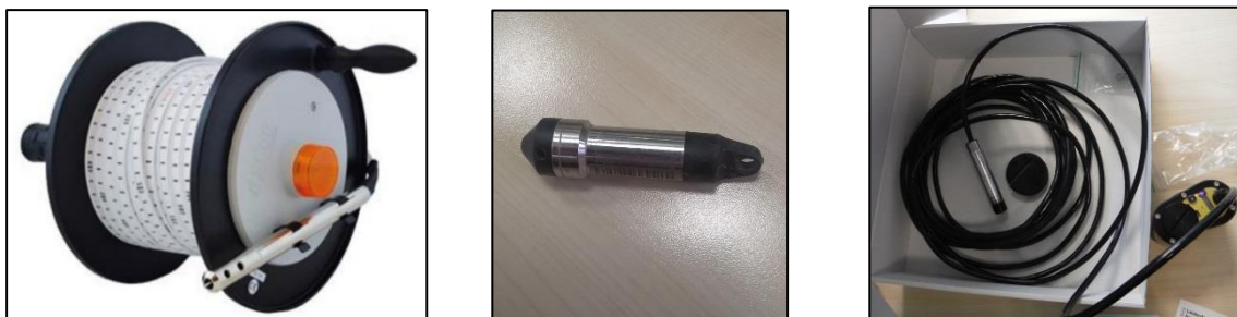
Figuur 7 waterpeilmeetlint en dataloggers voor het opmeten van de grondwaterstand
