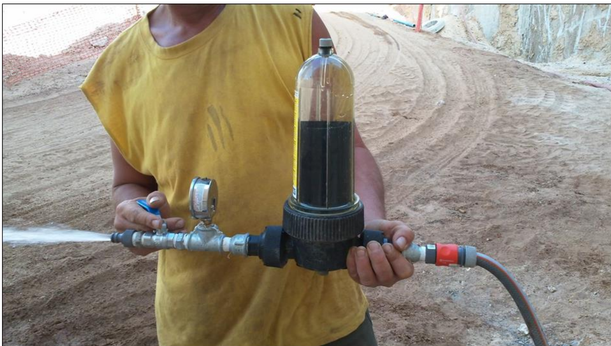
Figuur 39 illustratie van het meten van de ontgassingsdruk
