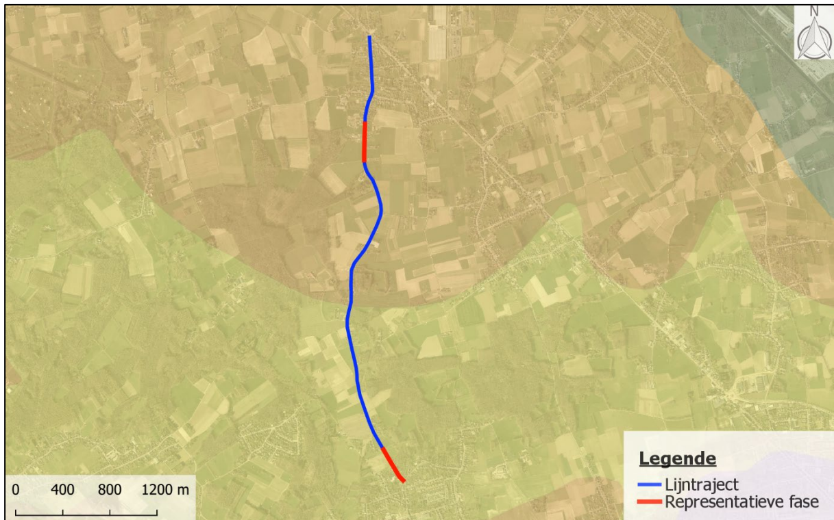
Figuur 3: Fictief voorbeeld van een lijntraject waarvan de ondergrond van het noordelijk deel voornamelijk uit kleihoudend zand bestaat (oranje) en de ondergrond van het zuidelijk deel uit fijn zand (geel).
