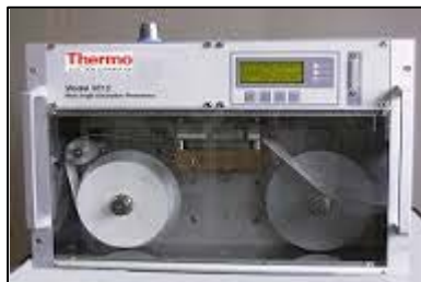
Figuur 5: MAAP-monitor gebruikt voor de bepaling van zwarte koolstof (BC)
