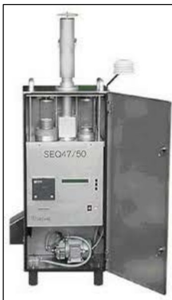
Figuur 4: Leckel SEQ 47/50, het referentietoestel voor de bemonstering van PM_{10} fijn stof
