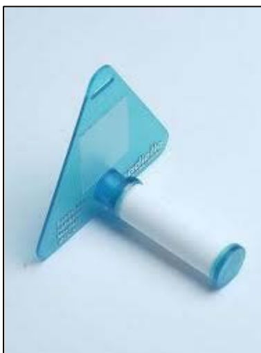
Figuur 7: Voorbeeld van een radiaal- of cilindervormig-type passieve sampler van het merk Radiello
