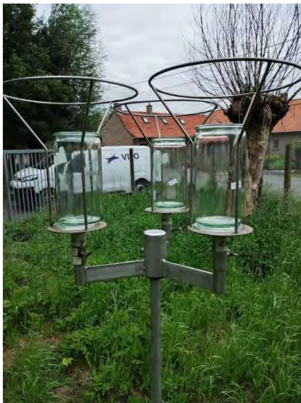
Figuur 3: Opstelling met drie Bergerhoff-neerslagkruiken in een houder op paal.
