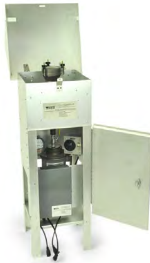
Figuur 1: Foto van de fijnstofbemonsteraar. Omgevingslucht wordt via de bemonsteringskop bovenaan aangezogen.
