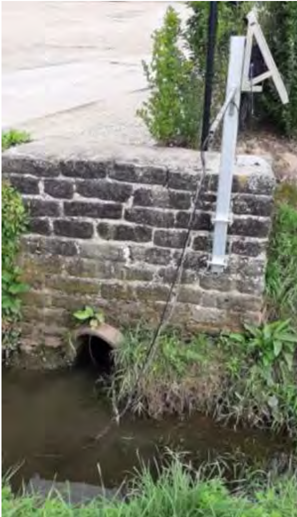
Figuur 17: Installatie van Nico+ nitraatsonde in de Babillebeek in Roeselare voor en na aanpassing van de kettinglengte.
