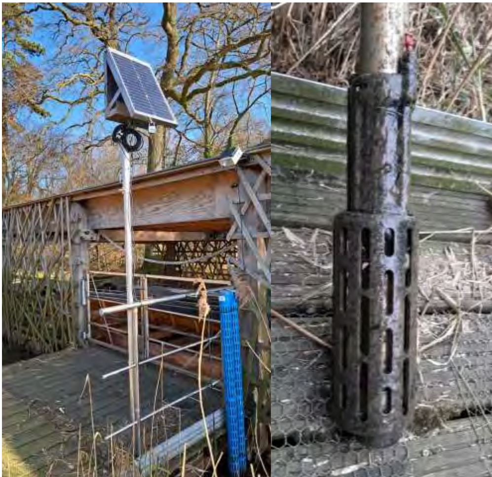
Figuur 2: Installatie van Nico+ nitraatsonde in De Blankaart, rechts de sonde bij een onderhoud
