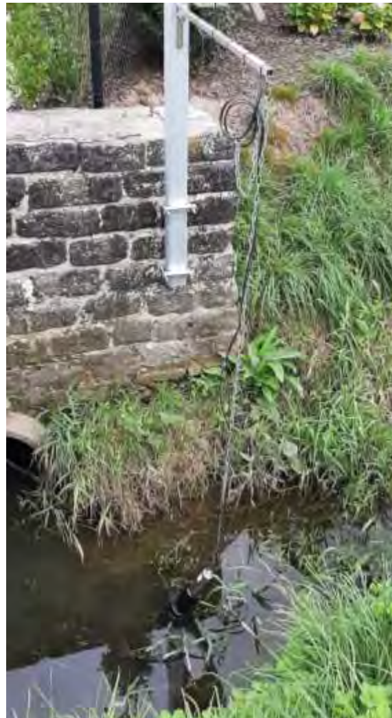
Figuur 17: Installatie van Nico+ nitraatsonde in de Babillebeek in Roeselare voor en na aanpassing van de kettinglengte.
