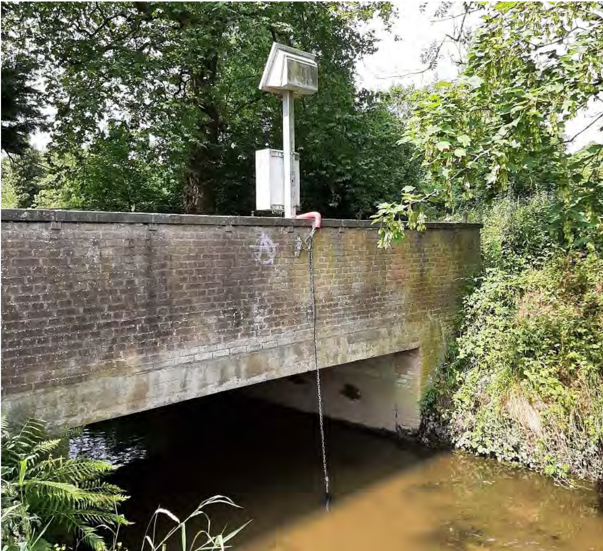
Figuur 7: Installatie van Nico+ nitraatsonde in de IJse in Neerijse
