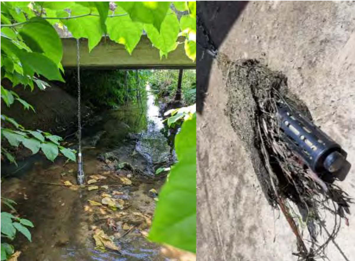
Figuur 10: Installatie van Nico+ nitraatsonde in de Grote Struisbeek ter hoogte van de Mastboomstraat in Aartselaar.. Rechts de sonde bij een onderhoud. Op deze locatie blijven er veel platen aan de sonde hangen.
