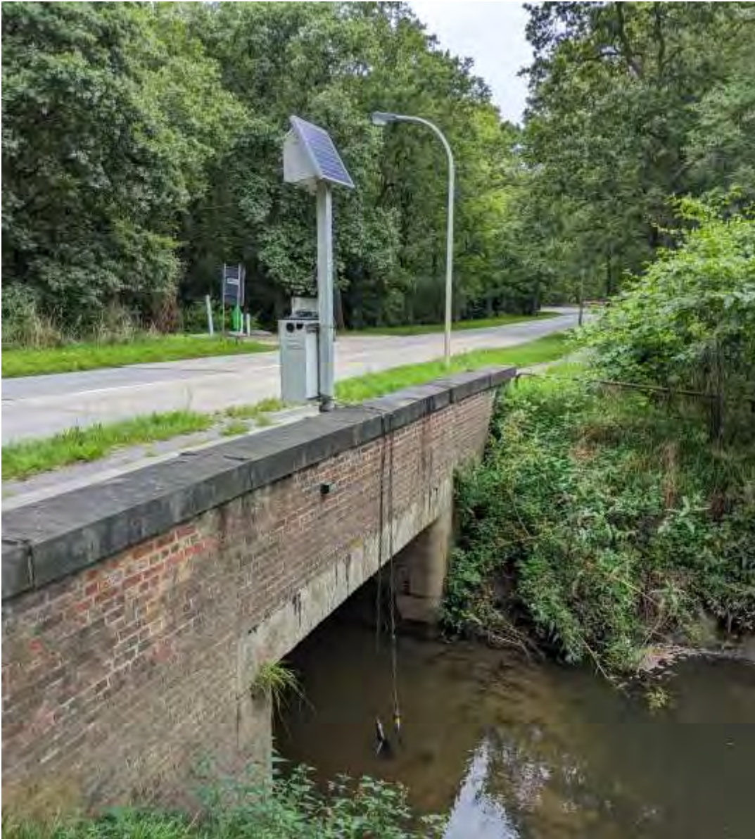
Figuur 11: Installatie van Nico+ niraatsonde in de Grote Struisbeek ter hoogte van de Cleydaellaan in Aartselaar
