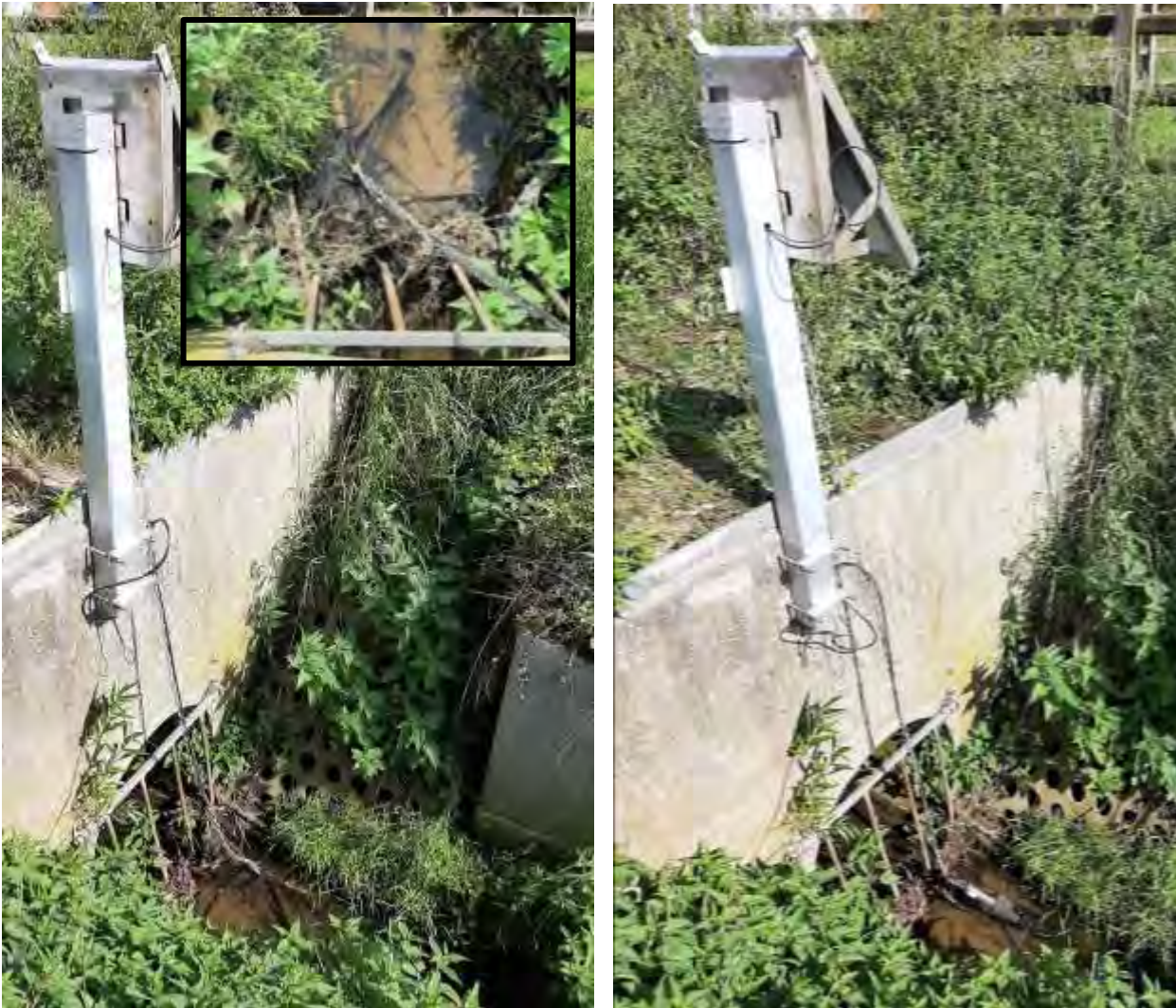
Figuur 16: Installatie van Nico+ nitraatsonde in de Bosbeek in Izegem voor en na de aanpassing van de kettinglengte.
