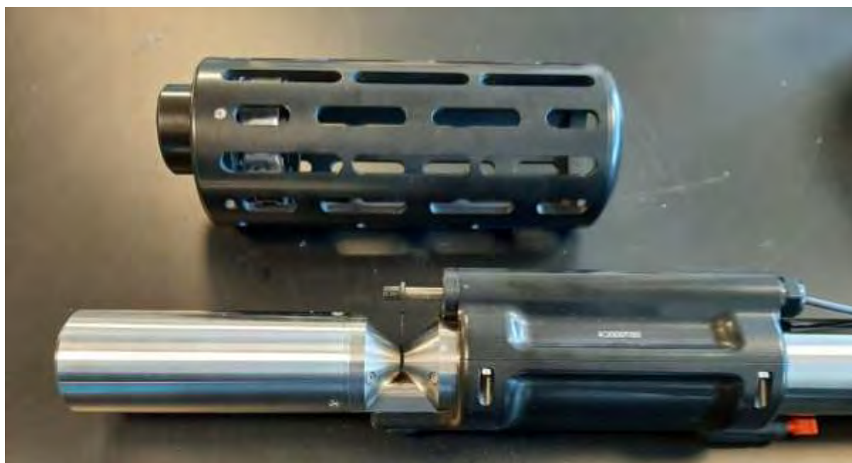
Figuur 19: Foto van de NICO+ sonde met centraal de meetopening met wissel.
