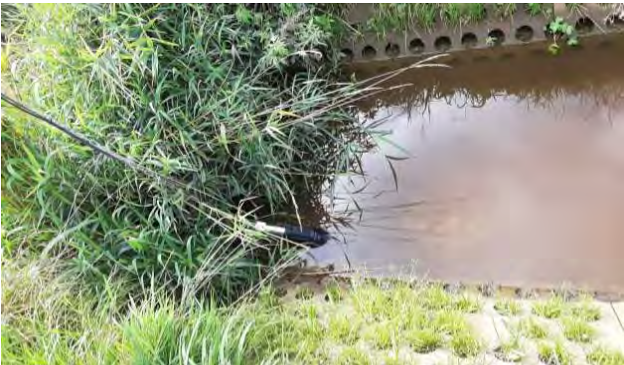
Figuur 15: Installatie van Nico+ nitraatsonde in de Mandel in Staden.
