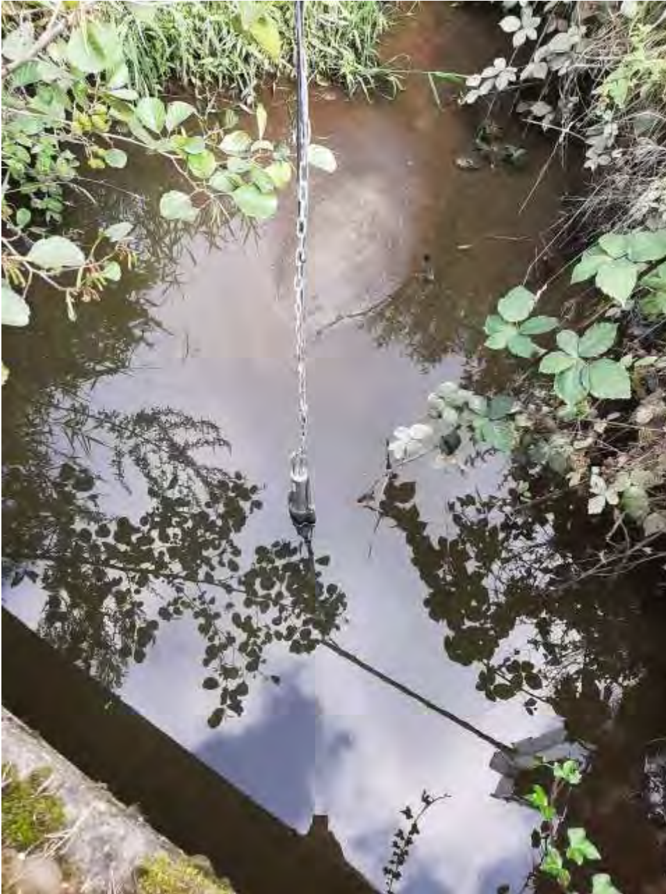
Figuur 18: Installatie van Nico+ nitraatsonde in de Coliievijverbeek in Moorslede.
