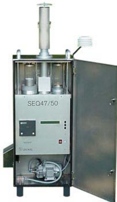
Figuur 18: De Leckel SEQ 47/50 die gebruikt werd voor de bemonstering van PM 10 .
