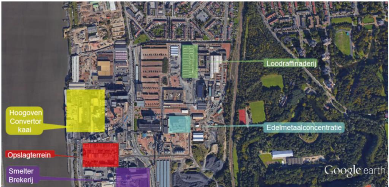
Figuur 2: Situering van de verschillende proceseenheden op het industrieterrein van Umicore (bron: Umicore).
