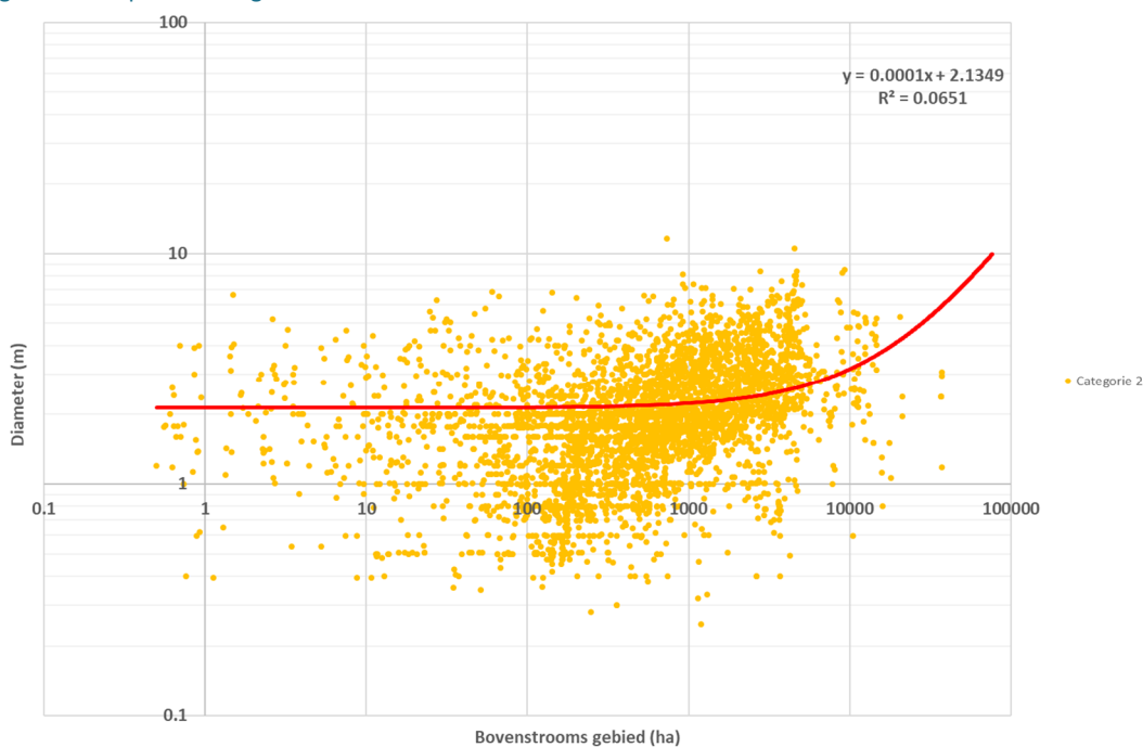
Figuur 2: Correlatie van berekende diameter en bovenstroomse oppervlakte van duikers van Categorie 2, de regressielijn is gebaseerd op de volledige dataset.
