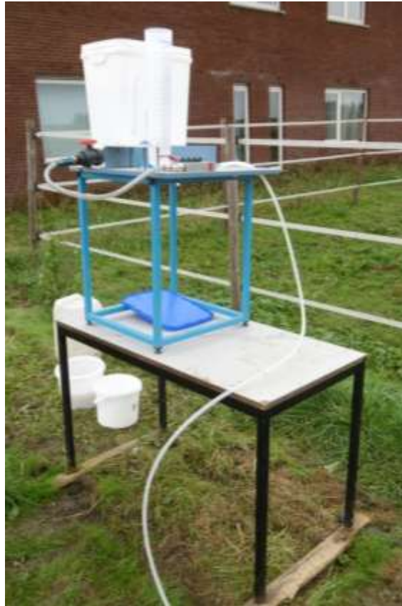
Foto 2: Tafel met statief, kranenblok waterreservoir, meetcilinders en aanvoerslang.
